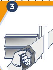
3 С помощью стусла и ножовки (или торцовочной пилы) запилите изделие под нужным углом и на нужную длину
