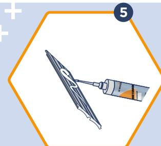
5 Нанесите монтажно-стыковочный клей HD 1000 на заднюю поверхность изделия
