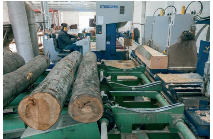
Распиловка бревен на производительной итальянской пилораме.
