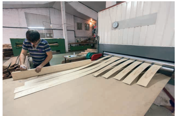
Строгание и сушка шпона на японском оборудовании.
